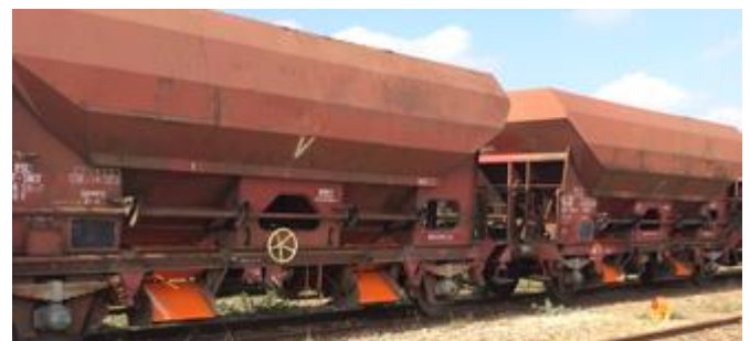
Train de ballastage en France protégé par les plaques anti-bruit mise au point par la société FIMOR
