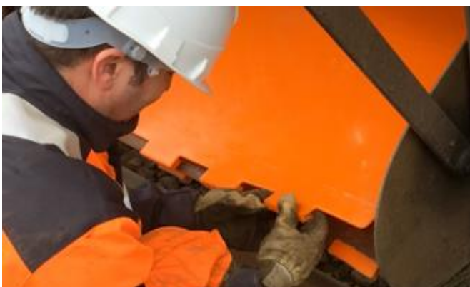
Train de ballastage en France protégé par les plaques anti-bruit mise au point par la société FIMOR
